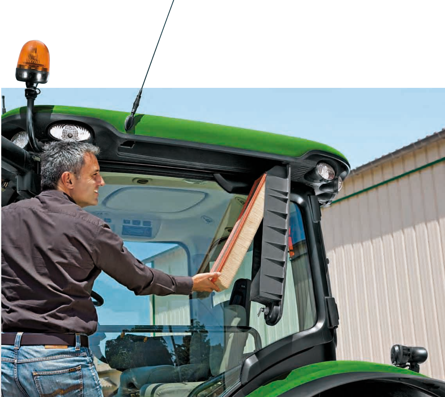
Замена фильтра вентиляции кабины – дело одной минуты!
